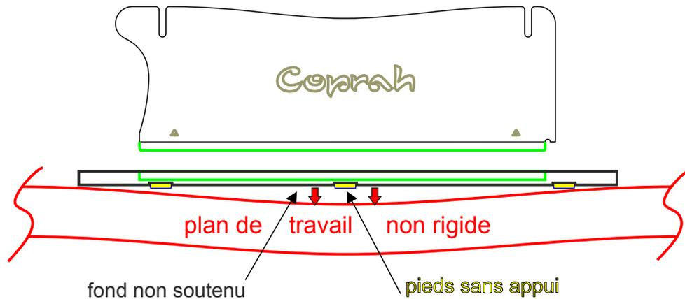
La pose du moule sur un support non rigide ou une surface molle entraînera la déformation du « fond » sous le poids de la pâte. Le fond du moule non soutenu comme il est prévu se déformera et n'assurera pas une bonne étanchéité (A vide, tous les pieds du fond doivent être en contact avec le plan de travail).
