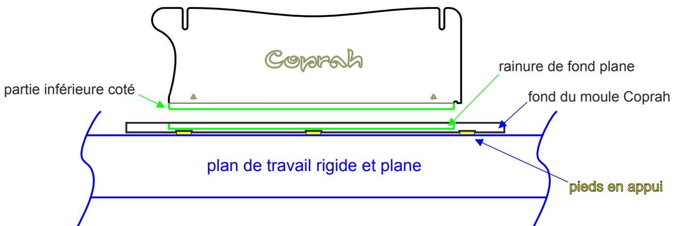
Pour obtenir une bonne étanchéité, il est nécessaire d'avoir un plan de travail rigide et plane. La partie inférieure des cotés (tracé vert) doit entrer en contact sur toute la longueur avec le fond de la rainure.
